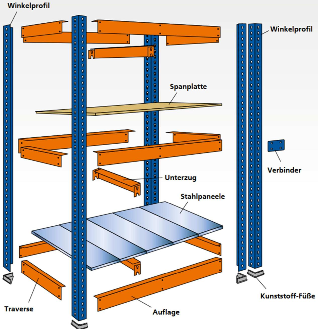
Das Z1 – Regalsystem ist vollsteckbar und daher besonders leicht zu montieren. Das System besteht ausschließlich aus Grundregalen, die mit Verbindern verbunden werden!
